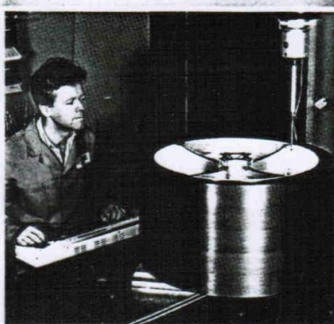
Svänghjul i kompositmaterial, utvecklat för ESA, och avsett för lagring av solenergi i rymdstationer.
